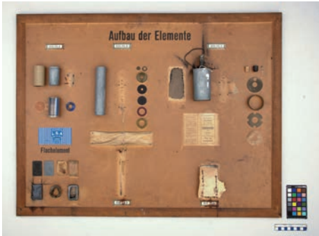
Fig. 1 : Plaque présentant les divers types de piles sèches Leclanché de l'Armée suisse (années 1950-1960). Les piles prêtes à l'emploi, la pile de campagne et les éléments plats. Avant traitement ©Noémie Nydegger, HE-Arc CR, 2023
