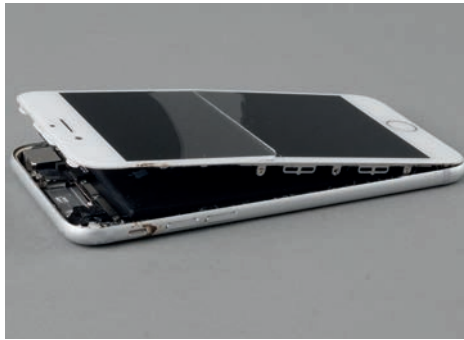
Abb. 2: Gebrochenes Display eines iPhone 7 (2017) aufgrund der aufgeblähten Lithium-Polymer-Pouch-Zelle (Olivier Ruch 2023)
