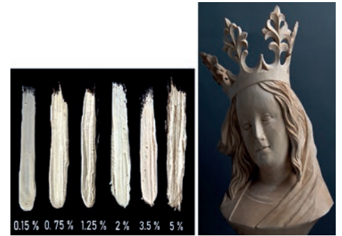
Abb. 3: Fotodokumentation der praktischen Studien: Aufstriche aus Bleiweiss/Leinöl-Mischungen mit steigenden Proteinkonzentrationen (li.); Kopie der Maria in Lindenholz, erstellt von Marcel Eyer, Fachlehrer, Holzbildhauerschule Brienz (re.) (Thenen, 2023)
