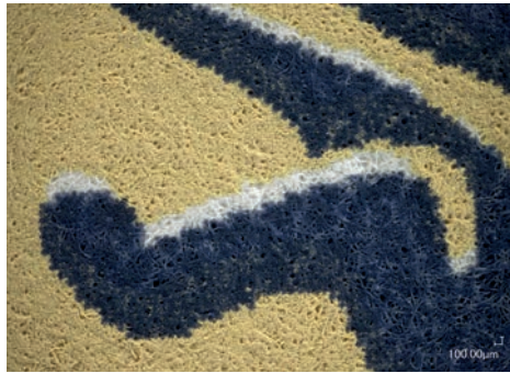
Abb. 2: Mikroskopaufnahme einer Serigrafie, mit Gouachefarbe und Siebdruckpaste gedruckt. Gut erkennbar sind der «Sägezahneffekt» an den Druckbildkanten und ein leichter Versatz des Druckbildes (Aufnahme mit Digitalmikroskop: M. Kupper, 2022)
