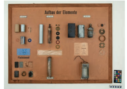
Fig. 3 : Plaque présentant les divers types de piles sèches Leclanché de l'Armée suisse (années 1950-1960). Les piles prêtes à l'emploi, la pile de campagne et les éléments plats. Après traitement ©Noémie Nydegger, HE-Arc CR, 2023
