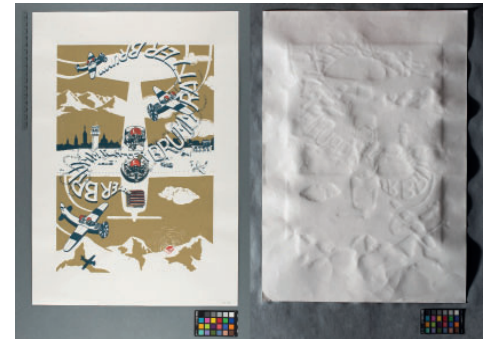
Abb. 3: Auflichtaufnahme recto (li.) und Streiflichtaufnahme verso (re.) einer Serigrafie, mit wasserbasierten Siebdruckfarben gedruckt. Die Reaktion des Papiertägers auf den Wassereintrag lässt sich verso im Streiflicht klar erkennen (Fotografie: M. Kupper, 2022)
