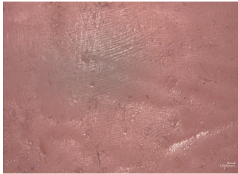
Abb. 2: Oberflächenmorphologie von Objekt 1: Rosafarbenes Polysiloxan-Elastomer mit Werkspuren, glänzendem Film aus niedermolekularem Polysiloxan, Staubpartikel. (Balken = 1 mm; Aufnahme mit Digitalmikroskop, Sophia Zehnder 2023)
