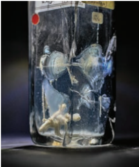
Fig. 1 : Photo de détail montrant un exemple extrême d'altérations chimiques et physiques du verre dans les collections de spécimens en fluide. ©HE-Arc CR, Museum Vrolik, A. Dupuis, 2023
