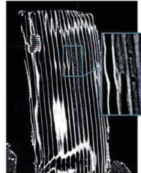
Fig. 2 : Coupe radiale d'un échantillon de bois de sapin consolidé au *Plexigum® PQ611* à 20% sans conditionnement. La répartition du liquide est discontinu et des bulles se forment. Observations réalisées sous le nanotomographe Skyscan 2211 du laboratoire de géologie de l'Université de Fribourg. Réalisé par V.D. Jaramillo 2017
