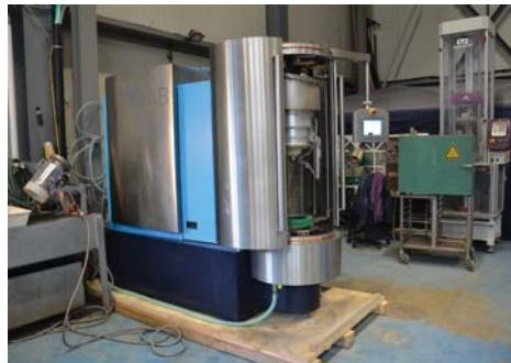
Fig. 1 : Der SELFRAG Lab Fragmentor der Firma SELFRAG AG wurde für die Durchführung der Versuche verwendet
