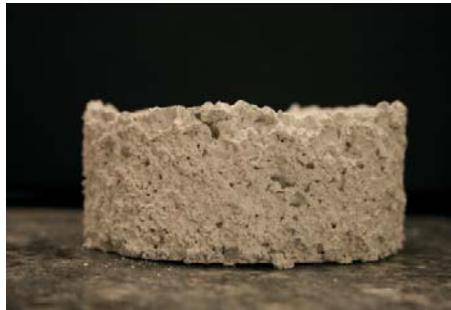
Fig 1: Campione realizzato con malta espansiva per il test di analisi della permeabilità al vapore.
