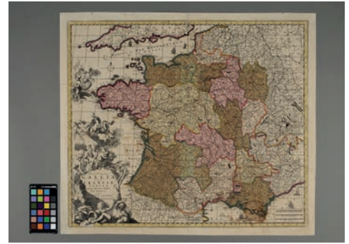
Abb. 3: Historische Landkarte von Frankreich, um 1690: Die Karte weist mehrere verbräunte, von Kupferfrass betroffene Bereiche auf (Natascha Eggimann 2022)
