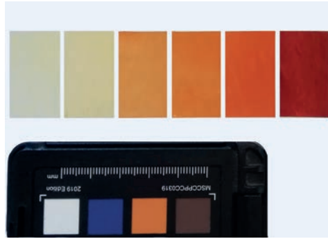
Abb. 2: Die untersuchten (semi-)transparenten Ölfilme von links nach rechts: 0 %, 0,1 %, 1 %, 2 %, 5 %, 20 % Nano-Eisenoxidpigmentpaste in Tungöllack (Pia Rasch 2021)
