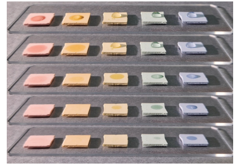
Abb. 3: Saugfähigkeitstest auf den farbcodierten Referenzschollen (ca. 1 cm²) mit je 5 µl deion. Wasser. Dabei ist ersichtlich, wie die verschiedenen Schollen das Wasser unterschiedlich schnell aufnehmen. Die Stufen der Skala werden von li. nach re. eingeordnet: sehr stark saugend (1) bis nicht/wenig saugend (5). (V.S. Murgia 2023)
