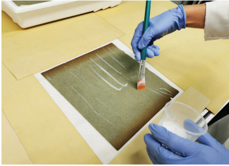
Abb. 1: Auftrug von 1,5%iger CNF-Dispersion auf Alumpapier mit Hilfe eines synthetischen Flachpinsels (I. Alaeva 2023)
