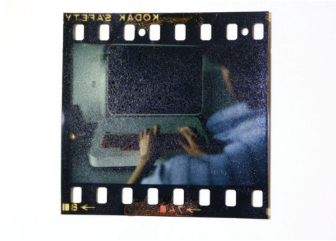
Abb. 1: Ausgerahmtes Kleinbild aus dem Filmtyp 5036 (Aufnahmejahr um 1980) mit Anlagerungen deutlich über dem Bildbereich (Isabelle Hasler, 2024)
