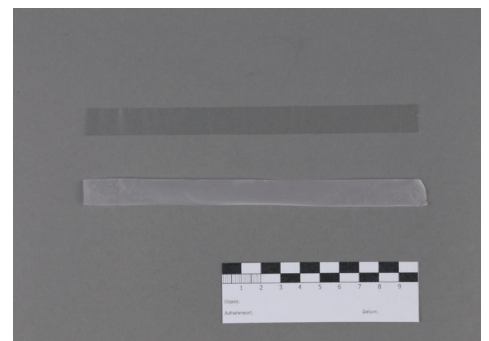
Abb. 3: MC A4M 4% Filme, oben ohne Zusatz, unten mit Vivapur CS 4 FM (GT 20:1) (Johanna Krailing, 4.11.2024)
