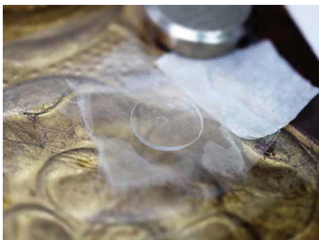
Fig. 2: Émulsion de Pickering stabilisée par des particules d'Aerosil® R208, constituée d'une phase polaire à base de carbonate de propylène (solvant actif) et d'une phase apolaire. L'émulsion de type « gel » est appliquée à la surface du cuir doré sur une interface en papier japon et recouverte d'un film en Melinex®. © HE-Arc CR, da Silva Henriques Océane, 2025.
