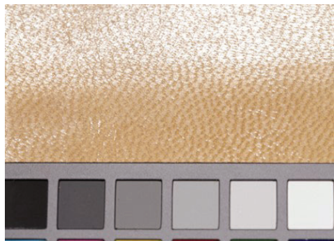
Fig. 3: Photographie en lumière incidente montrant la surface avant/après vieillissement UV d'un échantillon de cuir de chèvre traité par un lissage mécanique. La partie supérieure (premier tiers de l'image) correspond à l'état avant vieillissement ; la zone médiane (deuxième tiers) montre la même surface après 12 heures de vieillissement. (© Olivia Babey, 2025)
