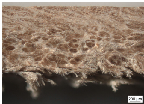
Fig. 1: Coupe transversale du cuir de bovin ayant reçu un apprêt + un lissage, compression de la zone papillaire et lissage des pores. (© Yvonne Gehrmann, 2025)
