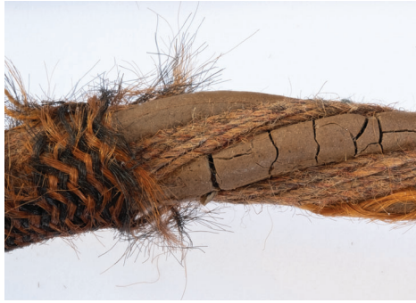
Abb. 2: Flexible Gummiaderleitung einer Zuglampe mit brüchiger Kautschukisolation, Tragseilen und gewebtem Mantel, vor 1950, Herkunft unbekannt (André Lison, 2024)
