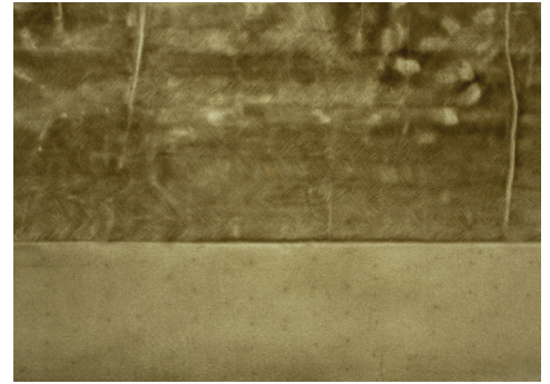
Abb. 3: Schattenpunkte im Papier, entstanden durch Siebnähte (Detail), Cartiere Miliani Fabriano. (S. Gomes, 19.05.2025)
