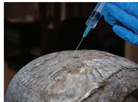
Fig. 3: Consolidation de la terre crue avec le mélange ternaire. Le traitement par imprégnation a été réalisé avec une seringue goutte à goutte et répété deux fois à distance d'environ 20 minutes entre une application et l'autre. © MAF/HE-Arc, Bovo Sofia, 2025.
