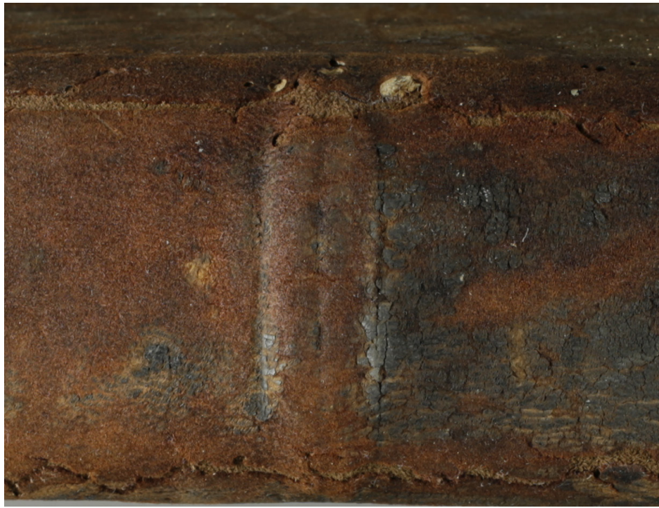
Abb. 1: Schadensbild einer pulvernden Lederoberfläche an einem Buchrücken. Durch Wasserkontakt wurde das Leder schwarz und brüchig (Objekt: Q3 Franziskanerkloster Freiburg; Foto: B. Schwarzmaier 2019)
