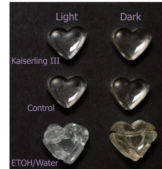
Fig. 3 : Échantillons dits « blocks » de HXTAL NYL-1 (époxyde) après 69 jours d'immersion, montrant la réaction entre le polymère et les fluides de conservation. ©HE-Arc CR, Museum Vrolik, A. Dupuis, 2023
